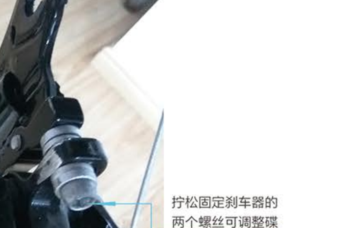
前叉口有凹口加弹簧垫片 弹簧垫片
